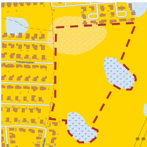
Figur 4. Utdrag ur jordartskartan med undersökningsområdet markerat med rödstreckad linje. Gult indikerar lera och ljusblått indikerar en sandig morän. För fullständig hänvisning se sgu.se (källa: Kartvisaren, sgu.se).
