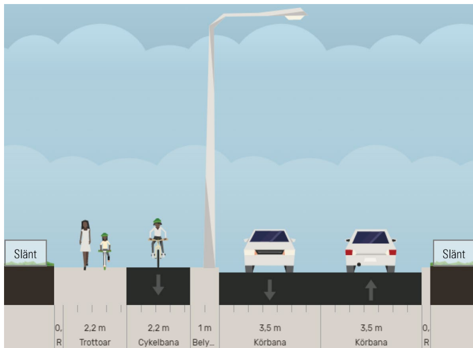
12. Föreslagen sektion för tillfartsgata. Sektionen visar inte hur hantering av dagvatten kommer att lösas.
