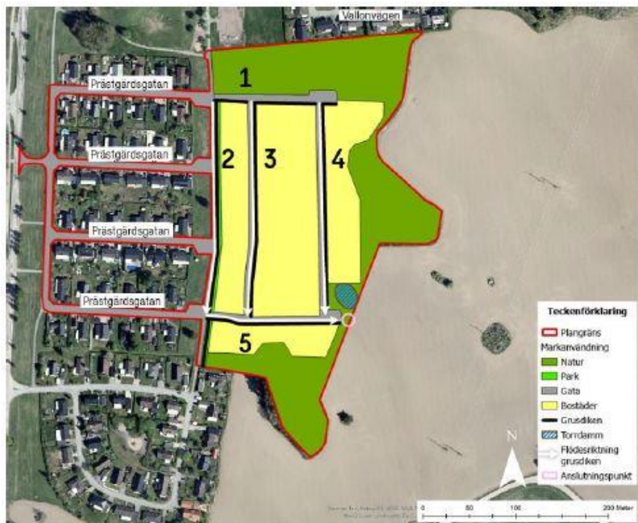
Figuren visar rekommenderade sekundära avrinningsvägar vid skyfall, dvs. lågstråk och lutningar i terrängen där stora volymer vatten kan avrinna.
