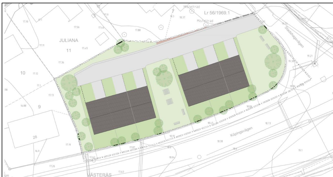
Figur 2. Ny planerad bebyggelse inom planområdet: 10 radhuslägenheter i 2 våningar, fördelat mellan två separata huskroppar.
