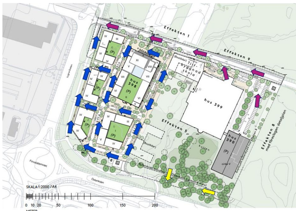
Figur 17 Förslag på sekundära avrinningsvägar vid skyfall. Rosa pilar avleds via Fredholmsgatan, blå och gula pilar avleds till befintliga gång och cykeltunnlar. Observera att plangränsen i nordöstra hörnet har justerats inför antagande. Källa: Sweco
