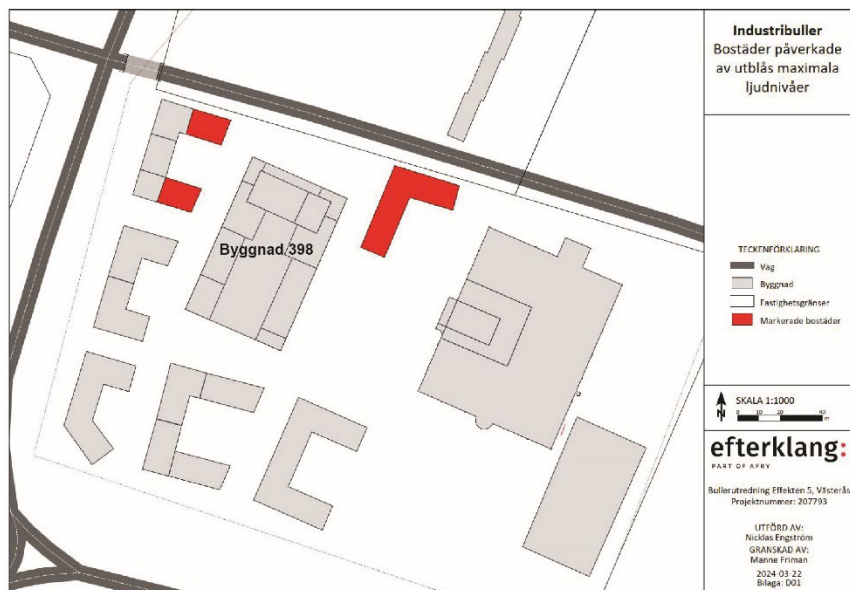
Figur 25 Byggrätter för bostäder som berörs maximalt verksamhetsbuller över riktvärdet nattetid i scenario 2. Dessa bostäder tilldelas planbestämmelse (m 4 ) om tillgång till ljuddämpad sida för att klara riktvärden för verksamhetsbuller enligt zon B. Källa: Efterklang
