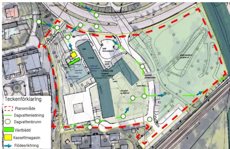
Figur 17. Förslag på systemlösning för planområdet. Illustration av Sweco.
