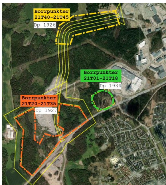
Figur 6. Skiss över utredningsområdet och numrering av undersökningspunkterna inom området. Vid utvärdering av materialparametrar har undersökningsområdet delats in i tre delområden enligt streckade markeringar i figuren.
