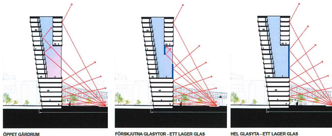
Figur 8. Principlösningar för inglasning av gårdsrum
